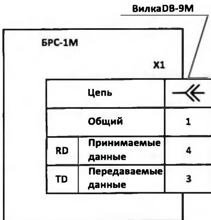
Рисунок 5 – схема электрическая подключения барометра
